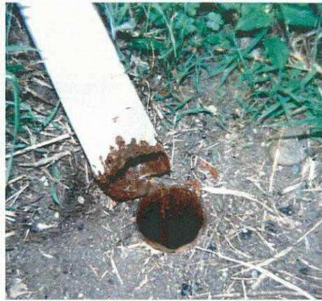
地際腐食により折れた支柱
